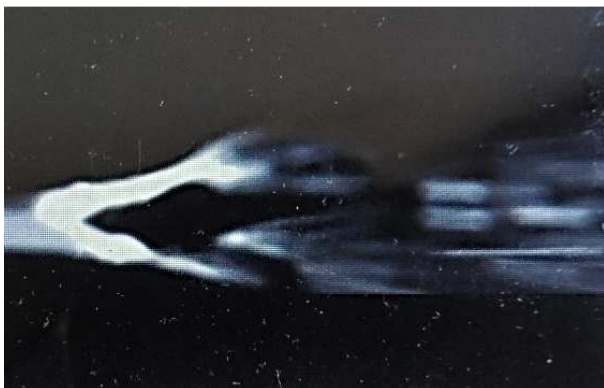
Рис 4. Плавление и диспергирование цинковых проволок при напылении методом ЭДМ
